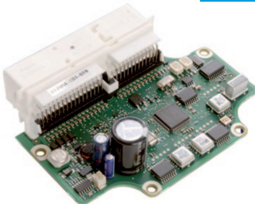
**D**ie Airbag Electronic Control Unit (AECU), die für die Steuerung des Airbags verantwortlich ist. In der Mitte der quadratische Mikroprozessor, auf dem die Steuersoftware läuft. Die hellen quadratischen Bauteile sind die Beschleunigungssensoren, die größeren zylindrischen Bauteile sind Kondensatoren, welche die elektrische Spannung für den Zündfunken liefern.
